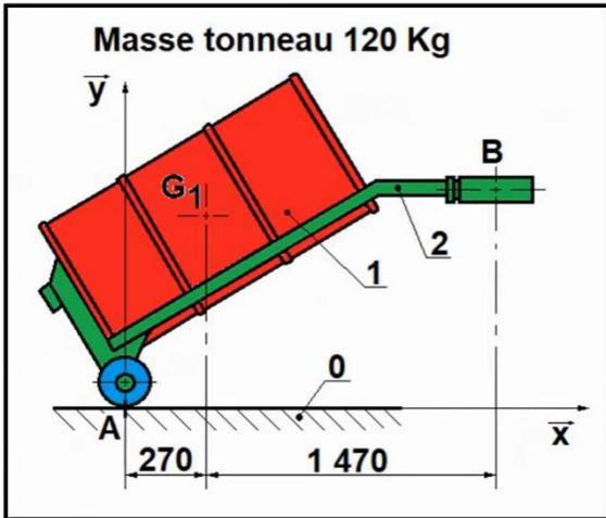
Déterminer les actions au niveau du contact entre les roues et le sol ainsi que l'effort à fournir par l'opérateur  $B_{op/2}$ .
